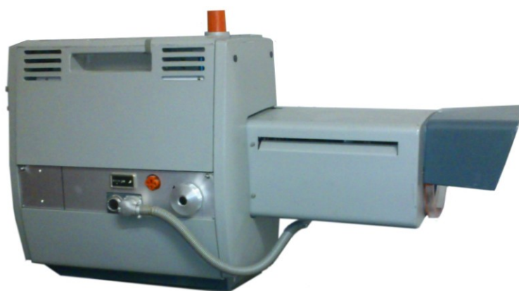
Philips "mini-compact" camera met vidicon en LDK Tv-kleuren-camera met 3 plumbicons
