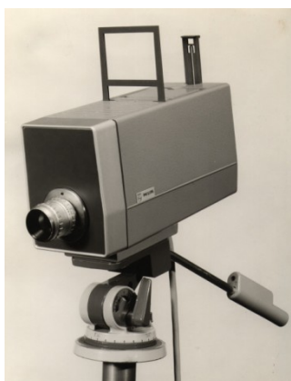
Philips "mini-compact" camera met vidicon en LDK Tv-kleuren-camera met 3 plumbicons
